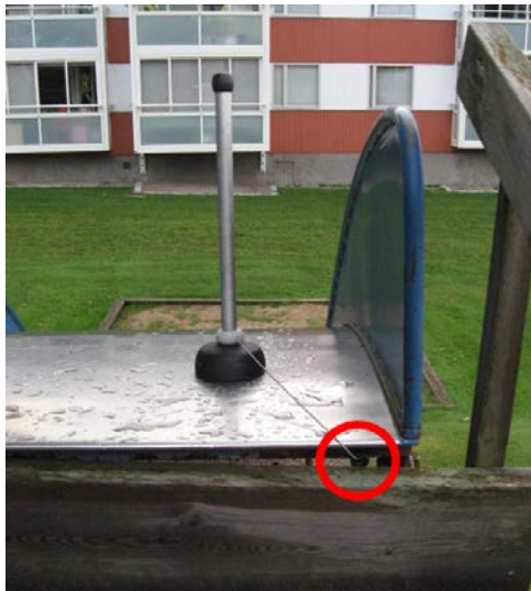
Provningsanordning för snodd på kläder har fastnat vid startdelen till en rutschbana.
