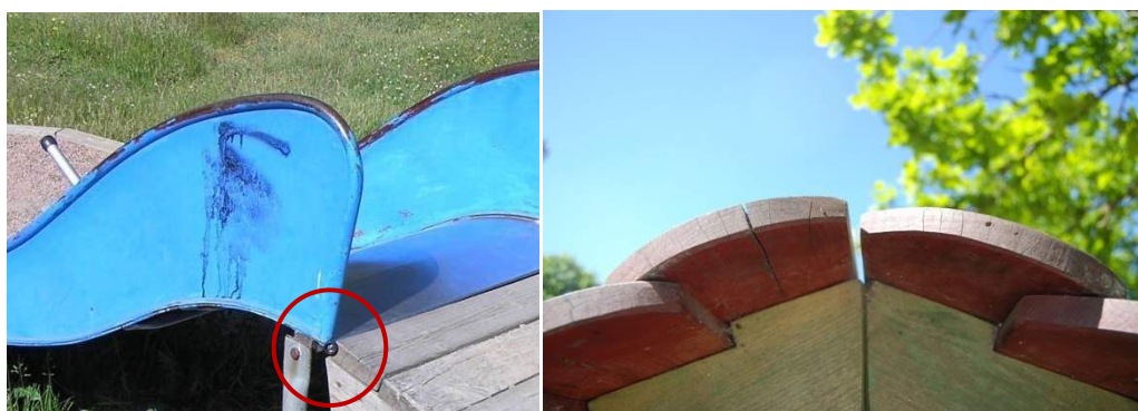
Provningsanordning för snodd på kläder har fastnat vid startdelen till en rutschbana
