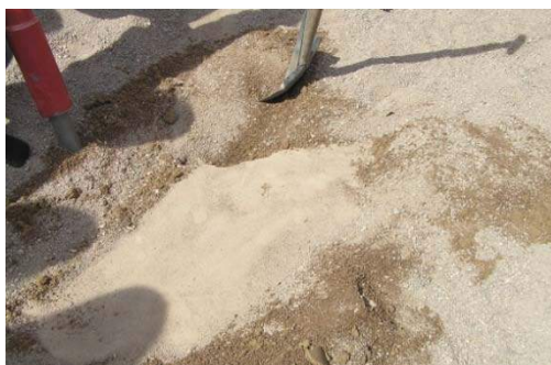
Felaktig sand har lett till att ett decimetertjockt betongliknande skikt bildats på lekplatsen.
